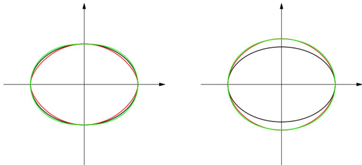
**Рис.:** Меридиональные сечения эллипса (черная линия), фигуры Гюйгенса – Роша (красная) и Ляпунова (зеленая); слева — с общими  $a, c, \alpha$  при  $\alpha = 0.25$ ; справа — с общими  $a, q$  при  $q = 0.22$ .
