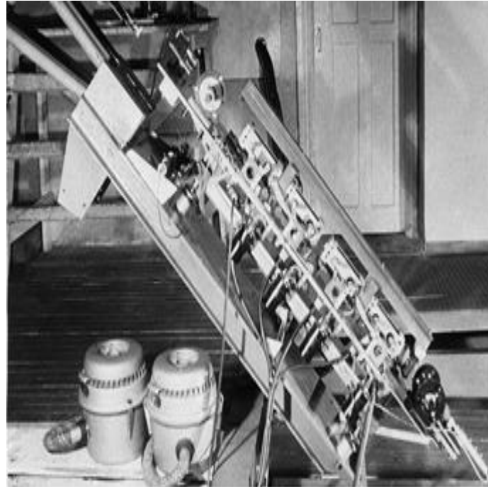
Рис. 1. Лазер на рубине в режиме свободной генерации с миллисекундным импульсом, около 50-70дж.
