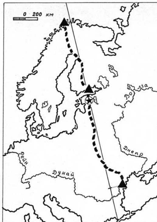
Рис.1. Схема тригонометрического ряда «русской дуги меридиана» 1816 – 1855 гг.
