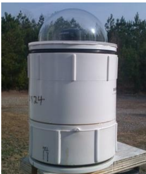
Рис. 1.5. Камера NASA's All Sky Fireball Network [34]
