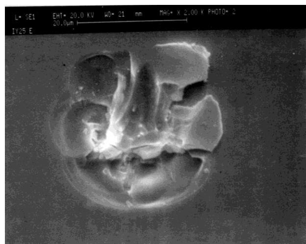
Рис. 1.17. – один из кратеров на поверхности солнечных батарей КА «Hubble Space Telescope» [3]
