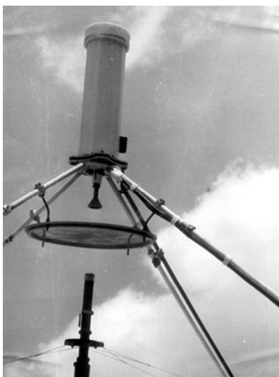
Фото 3. Конструкция совмещенного поляризационного облучателя радиотелескопа РТ-3 для приема излучения на волнах 2,0 см и 4,5 см.
