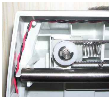
Рис.7. Натяжной шкив, зубчатый ремень, крепление направляющей.
