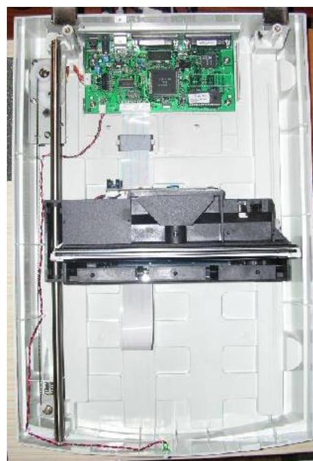
Рис.4. Система позиционирования светоприемника.
