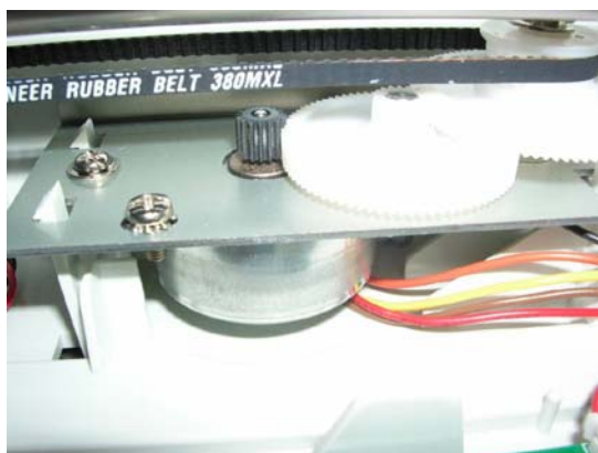
Рис.6. Шаговый электродвигатель и шестерни силовой передачи.
