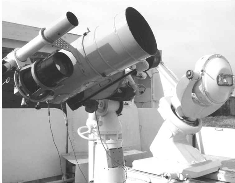
Рис.1. Параллактическая монтировка АПШ-40 с телескопом АЗТ-7, на базе которой делается робот-телескоп.
