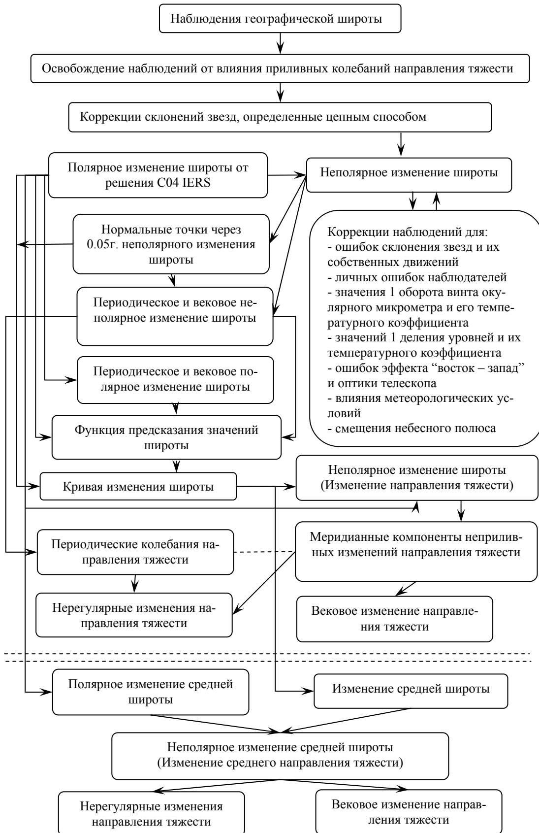
Рис.2. Блок-схема алгоритма для определения неприливных изменений направления тяжести от наблюдений географической широты.
