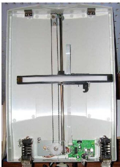
Рис.3. Система позиционирования осветителя.
