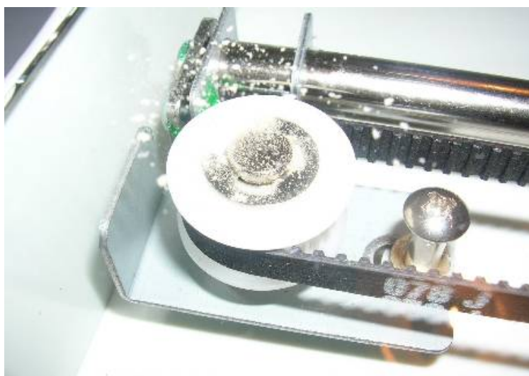
Рис.9. Частицы пластика от истираемой оси натяжного шкива, прилипшие к электризованному предметному стеклу адаптера.
