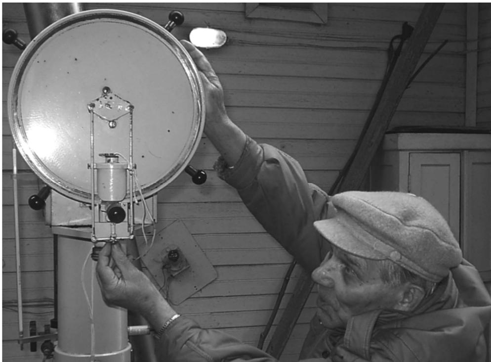
Во время обсуждения деталей конструкции зенит-телескопа ЗТФ-135
