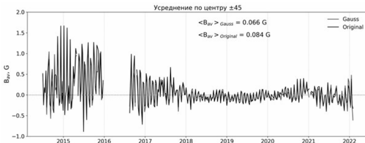
Рис. 4. Сравнение долговременных вариаций интенсивности магнитного поля, полученные методом гауссовой аппроксимации со стандартным методом, используемым в наблюдениях.
