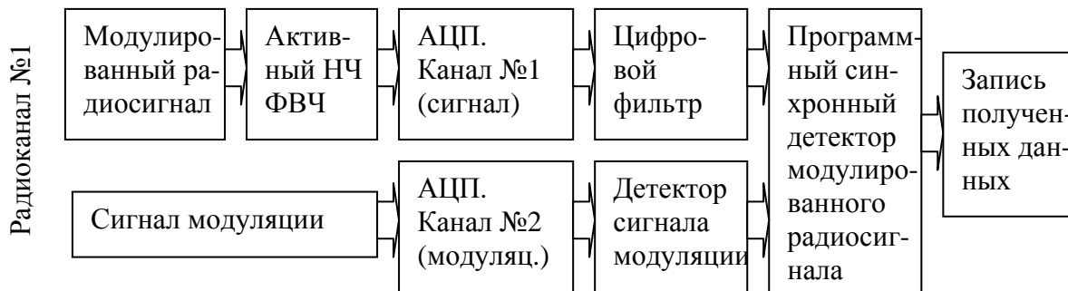
Рис. 1. Схема аппаратно-программного комплекса регистрации радиоизлучения Солнца.
