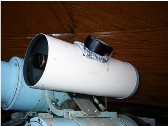
Рис. 3. Телескоп RST-220 с камерой ST-8 на монтажке АКД (Пулково).
