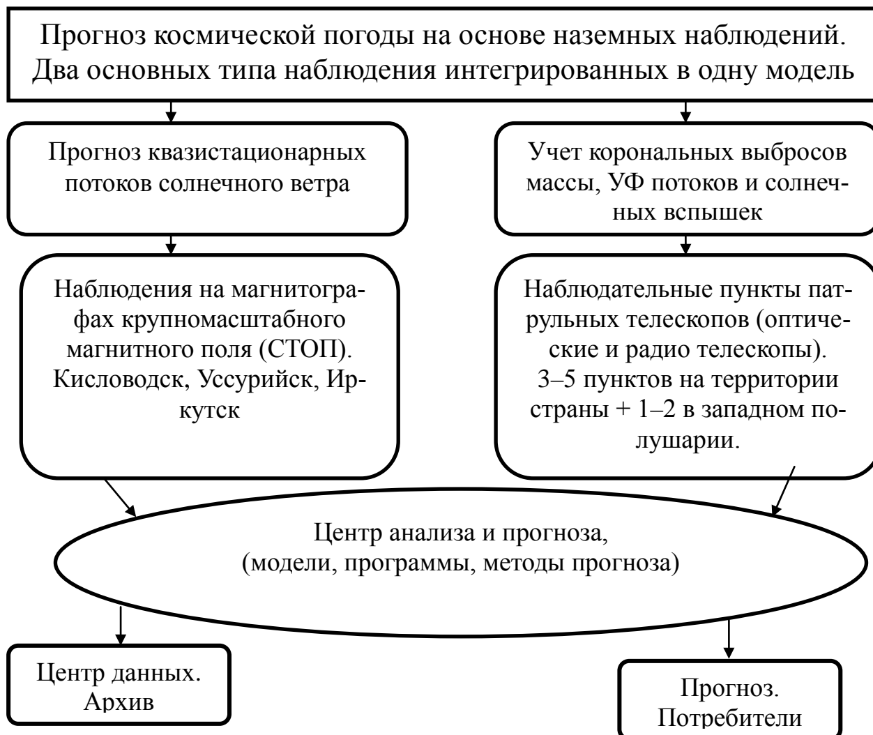
Рис. 1. Схема организации прогноза космической погоды на основе наземной наблюдательной сети.
