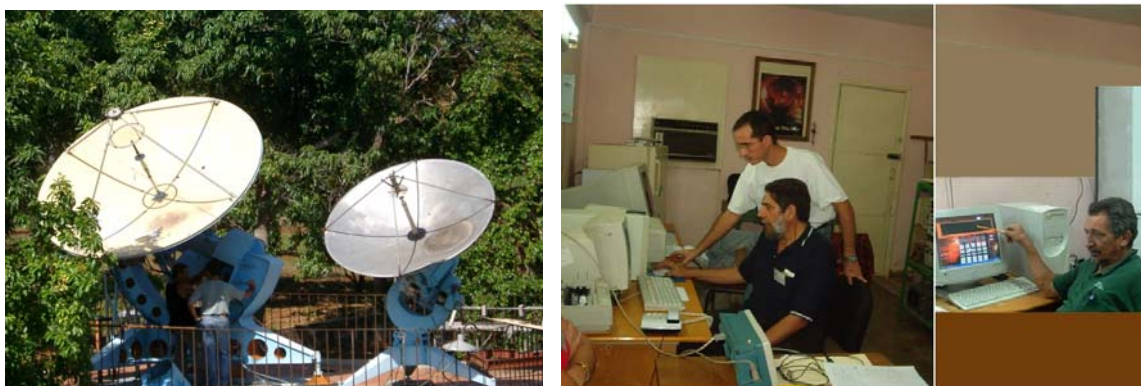
Рис. 2. Радиотелескопы ГРС в 1984 г. – слева РТ-3 ( \lambda = 4.5 см) и справа РТ-2 ( \lambda = 3.2 см). В аппаратной сидят Р.Е. Родригес (слева) и П. Сьерра (справа).
