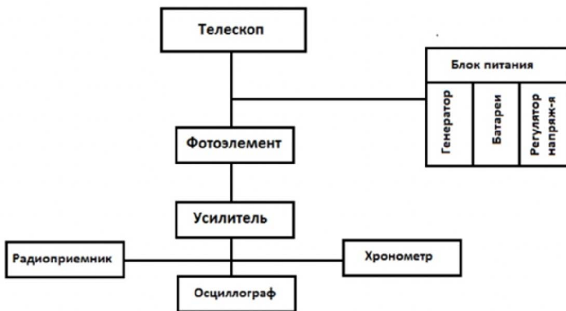
Рис. 1. Блок-схема установки для фотоэлектрического метода наблюдений покрытий.
