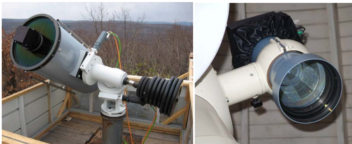
Рис. 2. Телескоп VT-40/500 апертурой 50 см и полем зрения 2,5^\circ в Уссурийске на монтировке WS-300 (слева), объектив VT-53e апертурой 125 мм и полем зрения 15^\circ в Уссурийске.
