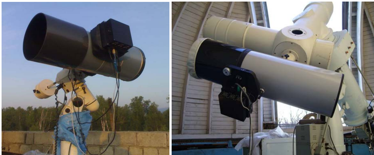
Рис. 1. Телескоп ORI-22 апертурой 22 см и полем зрения 5,5^\circ в Мильково (Камчатка) на автоматической монтировке EQ6Pro (слева), телескоп GAS-250 апертурой 25 см и полем зрения 3,9^\circ с турелью и фильтрами BVRI в Уссурийске на монтировке Кудэ-рефрактора (справа).
