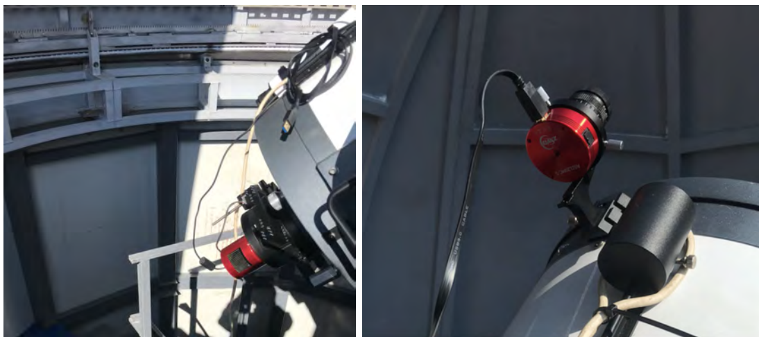
Рис. 5: Основная (ZWO ASI 1600MM Pro (mono), показана в левой части рисунка) и гидировочная (ZWO ASI120S, показана справа) камеры пулковского 40-см телескопа.
