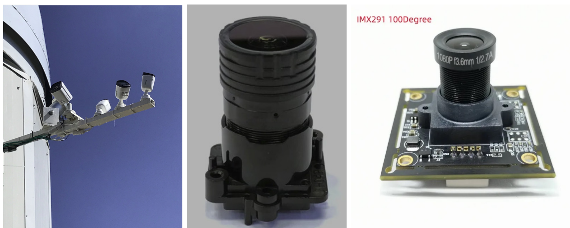
Рис. 2: Типичное оборудование, используемое в сети izMeteors. Слева: кронштейн с камерами сети izMeteors на павильоне пулковского 40-см телескопа в обсерватории Ассы-Тургень. В центре: плата сенсора IMX291. Справа: объектив F0.95 Starlight ( D=6 мм).
